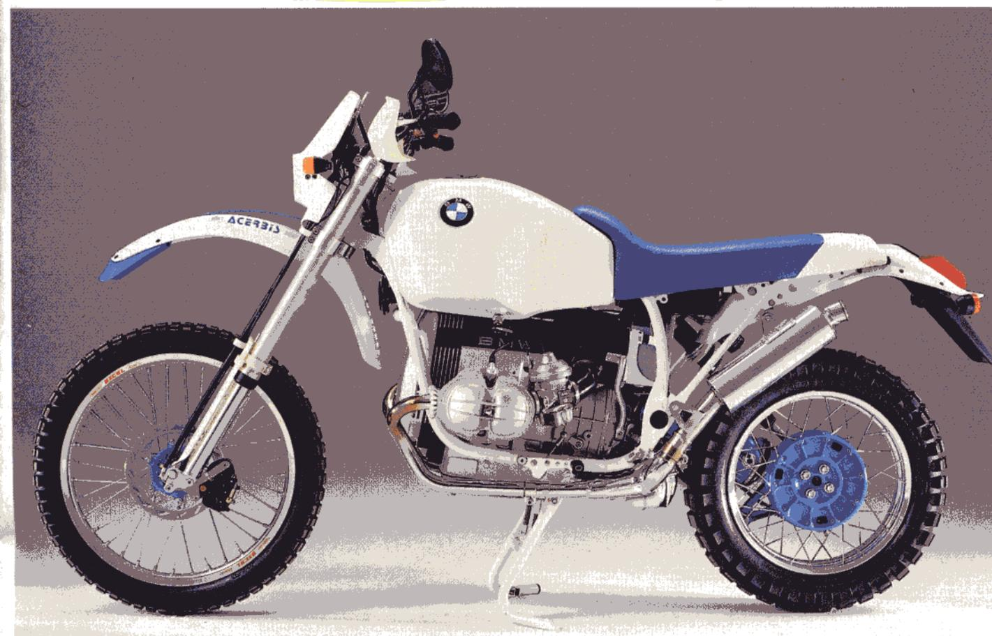
des Boxertriebwerks wird auf 1000 Kubikzentimeter erhöht und eine Sportnockenwelle eingebaut. Zwei Sebring-Endschalldämpfer sorgen für den guten Ton. Um das Kraftpaket zu bändigen, installiert Hinterreiter vorn eine Vierkolben-
